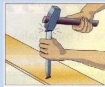
**Figura 4.8(e). Dureza.** Oposición que ofrece un cuerpo a dejarse rayar o penetrar por otro o, lo que es igual, la resistencia al desgaste.
